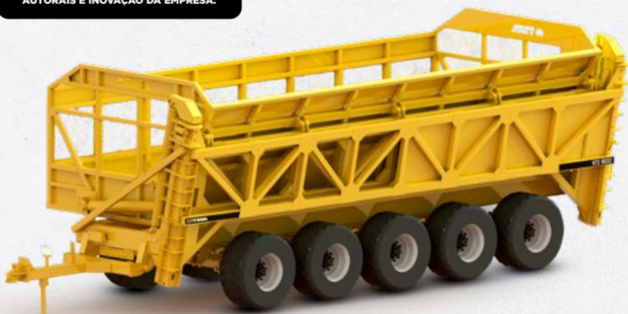
O transbordo de cana picada TMA se destaca pela robustez e desempenho operacional. Sua estrutura é dimensionada para suportar as mais severas condições operacionais. É adequado para rodotrem de PBT 91 toneladas, possibilitando o carregamento em apenas uma manobra por carreta, o que aumenta a agilidade da operação.
