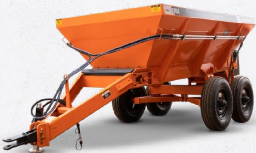
Equipamento para distribuição de calcário e adubo orgânico seco, acionado hidráulicamente, com sistema de esteira e distribuição centrífuga. Fácil engate e eixo tandem para estabilidade e compensação de desnível do solo.
