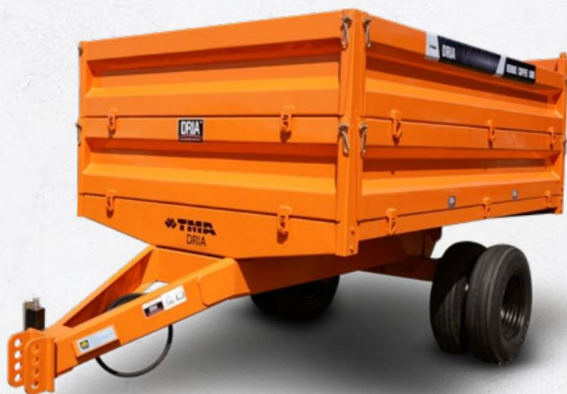
Carreta basculante com acionamento hidráulico, para transporte do café colhido. De fácil manuseio, a carroceria é modulada, sendo possível a articulação e remoção dos módulos que compõe o equipamento.
