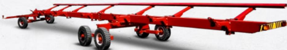
Equipamento para transporte de plataformas de colheitadeiras de soja de 35 pés. Fácil engate, braços com regulagem de distância e ângulo, e tandem para estabilidade em terrenos com desníveis. Eixo dianteiro com sistema de mola e rala, proporcionando praticidade em manobras.
