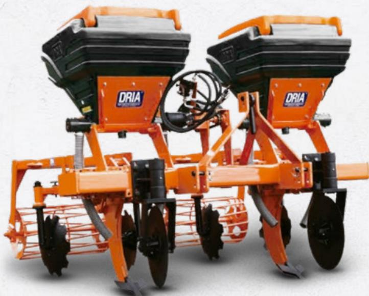
Implemento versátil de múltiplas ações para subsolagem, adubação e cultivo do plantio de cana-de-açúcar. Conta com discos para corte da palha, haste subsoladora, discos cobridores com regulagem de angulação de trabalho e rolo destorroador. O implemento também atua como sulcador/adubador.
