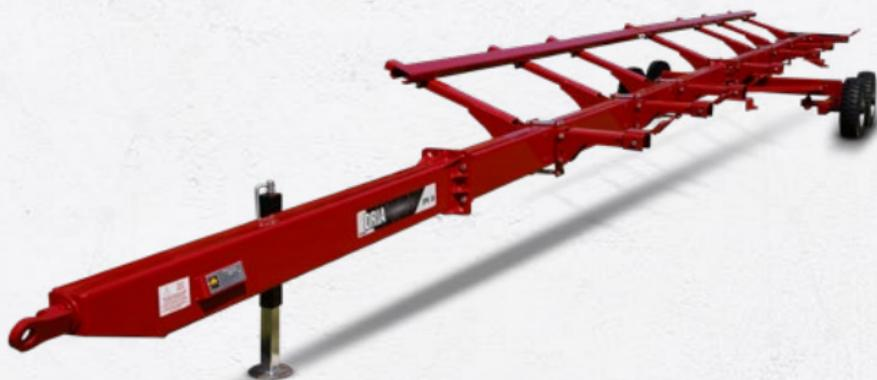
Equipamento para transporte de plataformas de colheitadeiras de soja e milho de 30 pés. Fácil engate, braços com regulagem de distância e ângulo, e tandem para estabilidade em terrenos com desníveis.
